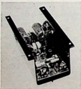
AM 50SP HI-Fi versterker met groot vermogen 45 - 55 V AC DC ingang 0,2 - 1 V 100 kΩ uitgang 30 - 55 W sinus 16-3,5 Ω 12 - 60.000 Hz 16 halfgeleiders
