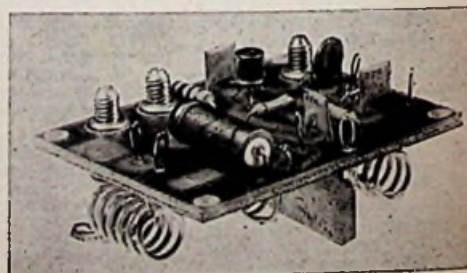
HF 1 Mosfet versterker voor 144 MHz 14 dB versterking 9 - 12 V AC DC
